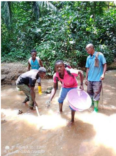
Photos 38 à 41 : Prélèvement dans un sondage de plus ou moins 1m, échantillon brut et échantillon lavé
